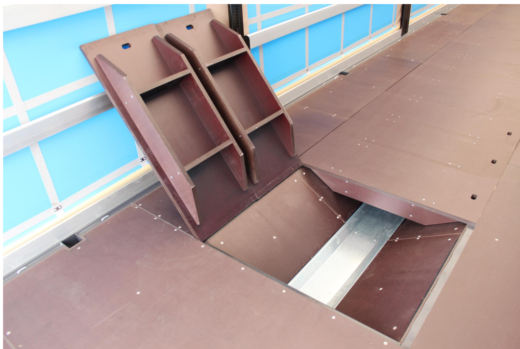
Zakrytí prohloubeného lůžka z tvrzené protiskluzové překližky tl. 27mm, pro přejezd vysokozdvížným vozíkem
