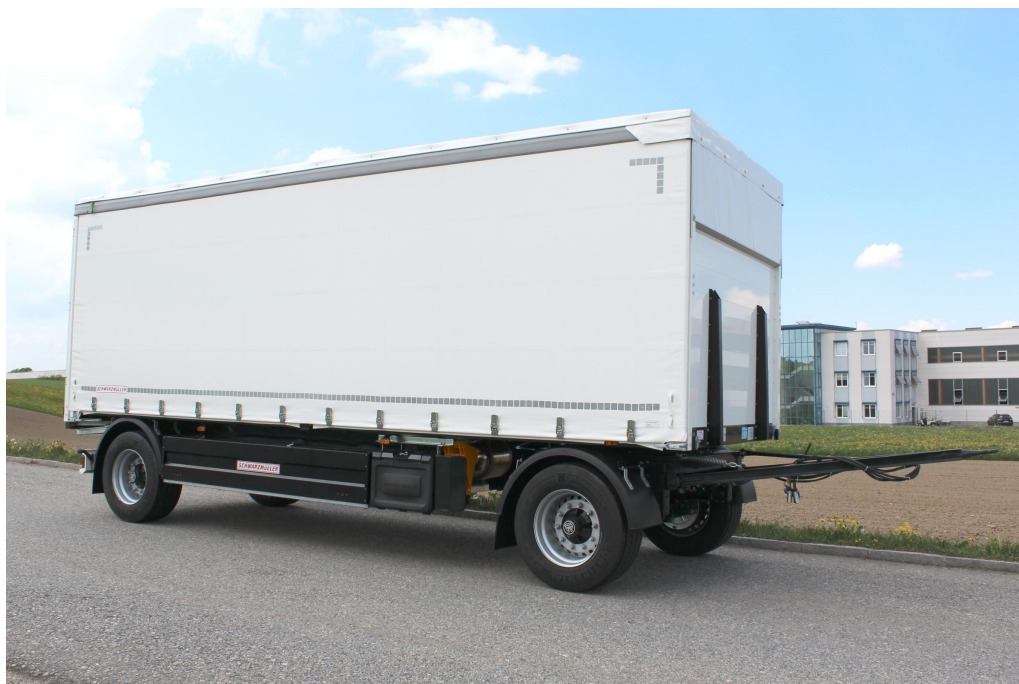
2-nápravový valníkový přívěs se stahovatelnou plachtou
