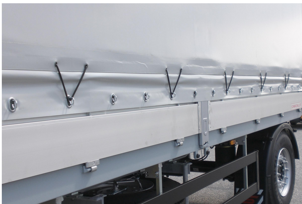
2-nápravový valníkový přívěs se stahovatelnou plachtou
