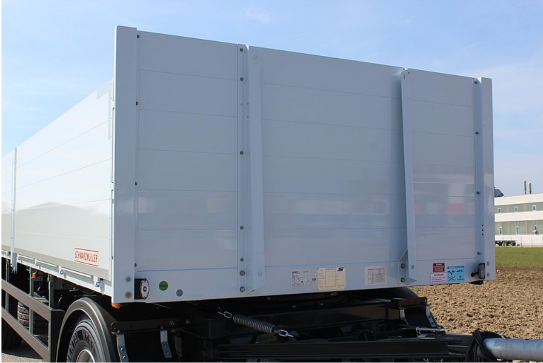
Pevná přední stěna z dutých hliníkových profilů se 2 středovými výztuhami přes celou výšku stěny
