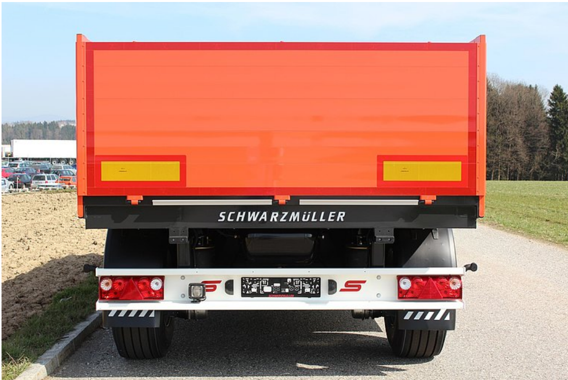
Sklopná zadní stěna z dutých hliníkových profilů, sklopné s KINNEGRIP dvojitým uzávěrem
