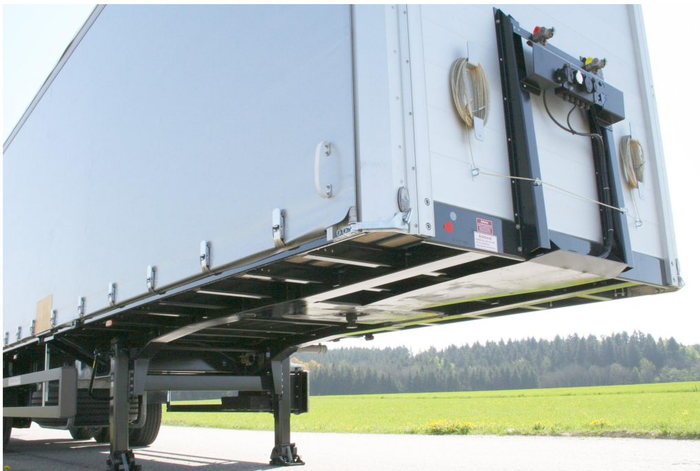
Tuhý žebřinový rám ocelové svařované konstrukce
