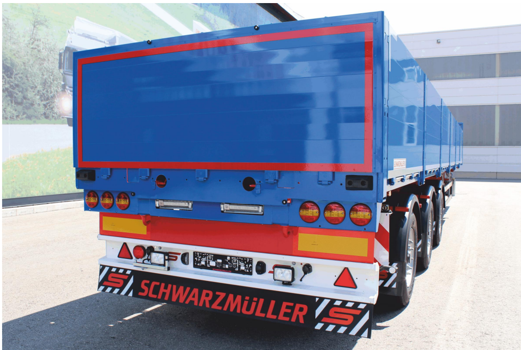
Zesílené zadní čelo z hliníkových dutých profilů, vysoké 1.000 mm
