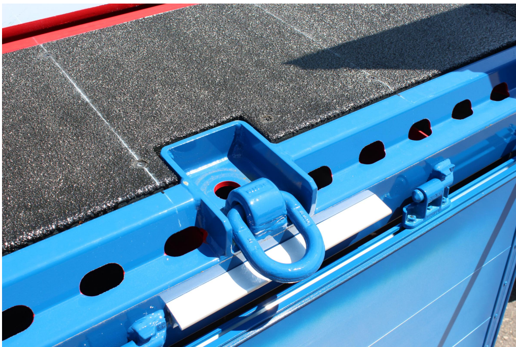
Děrovaný vnější rám s rozestupy děr cca 100 mm, otvory o rozměru 50/30 mm, pro kotvení nákladu - 2 t
