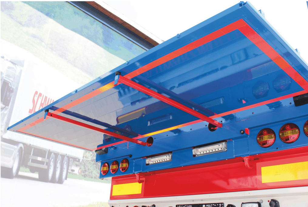
VOLITELNĚ: 2 výsuvné podpěry pro podepření sklopeného zadního čela (nezatížitelné)
