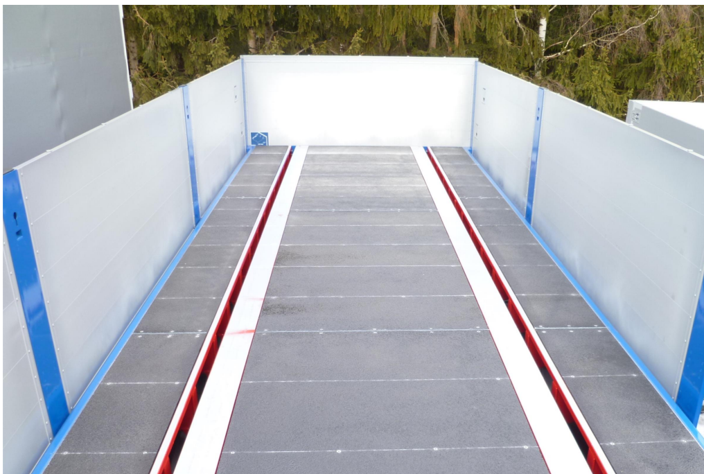
Zesílené zadní čelo z hliníkových dutých profilů, vysoké 1.000 mm
