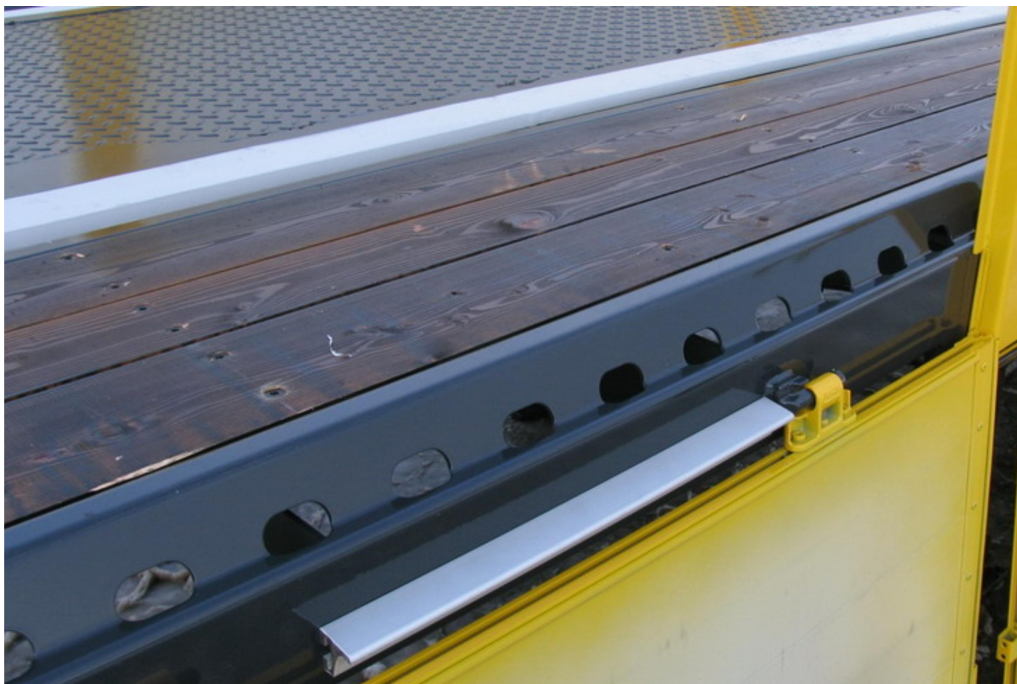
Děrovaný vnější rám s rozestupy děr cca 100 mm, otvory o rozměru 50/30 mm, pro kotvení nákladu - 2 t
