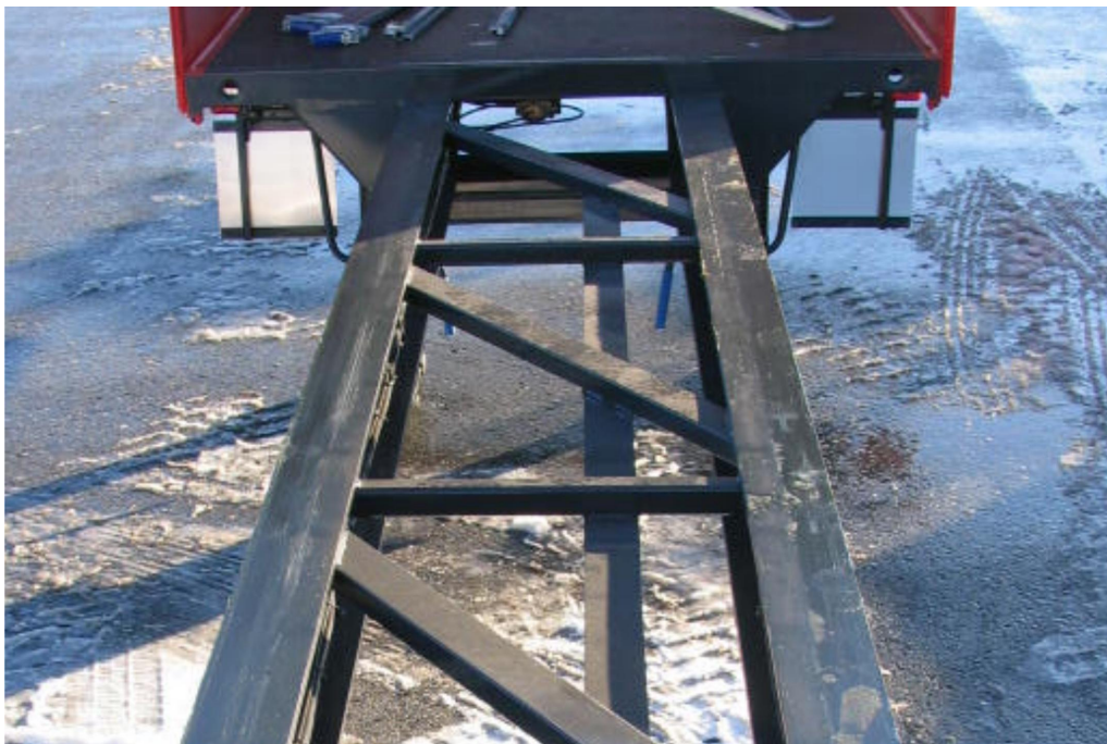
Roztahovatelný rám odlehčené konstrukce s délkou roztažení 6 m - pro přepravu dlouhého materiálu (až 22 m)
