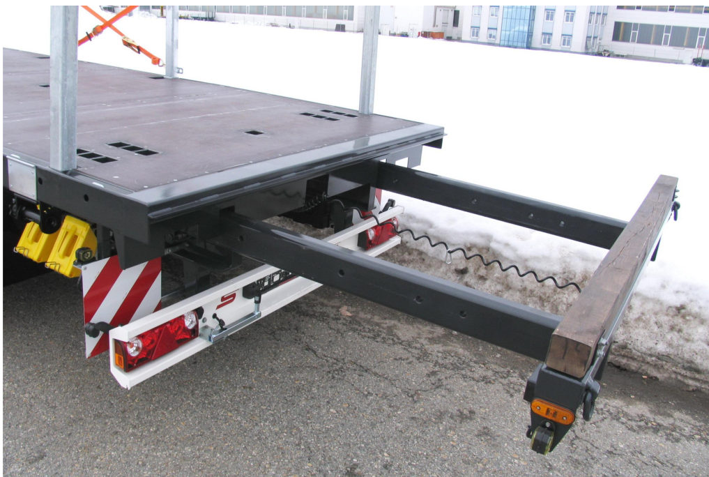
VOLITELNĚ: Zadní výsuvný rám, výsuvný na 1.500 mm (zatížitelný 2 t)
