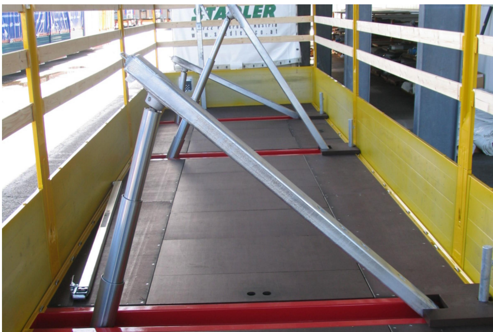
3-nápravový valníkový návěs Coil - lehké provedení - s možností šikmého uložení nákladu
