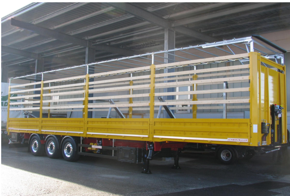
3-nápravový valníkový návěs Coil - lehké provedení - s možností šikmého uložení nákladu
