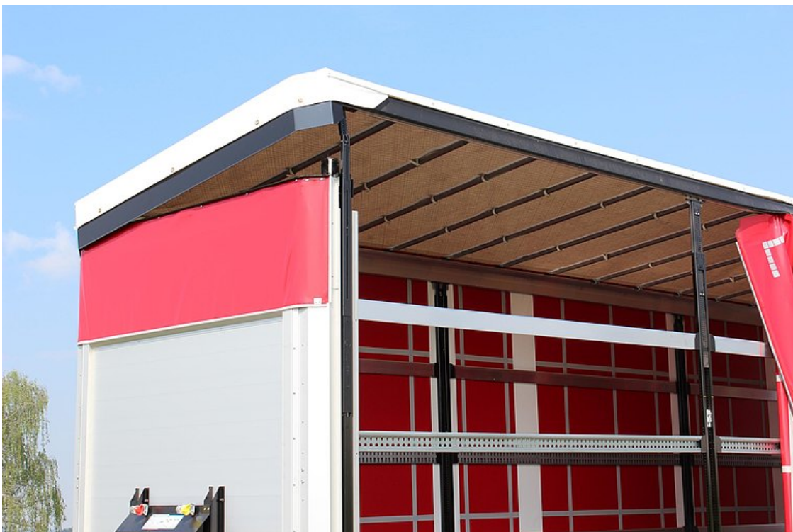
VOLITELNĚ: hydraulický Hubdach s manuálním ovládním se zdvihem 400 mm, pro rychlou nakládku a vykládku
