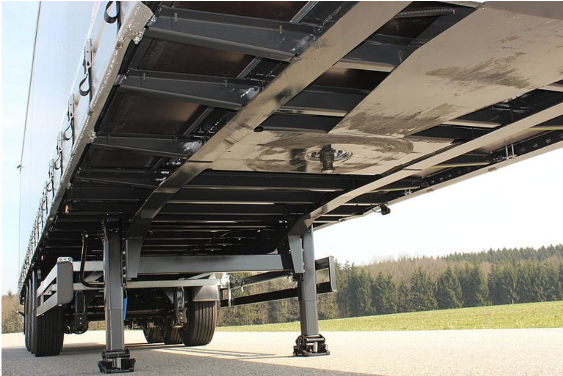
Tuhý žebřinový rám ocelové svařované konstrukce
