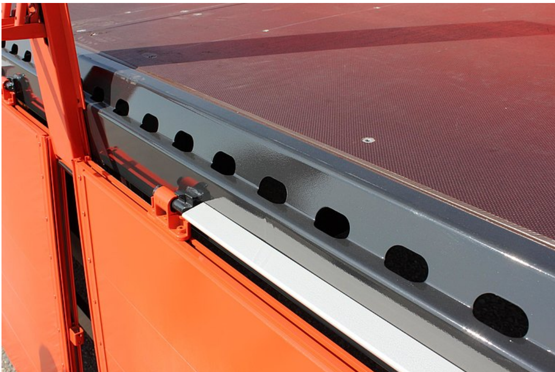
VOLITELNĚ: děrovaný vnější rám s roztečí otvorů po cca 100 mm, otvory o rozměru 50/30, pro kotvení nákladu - 2,5 t
