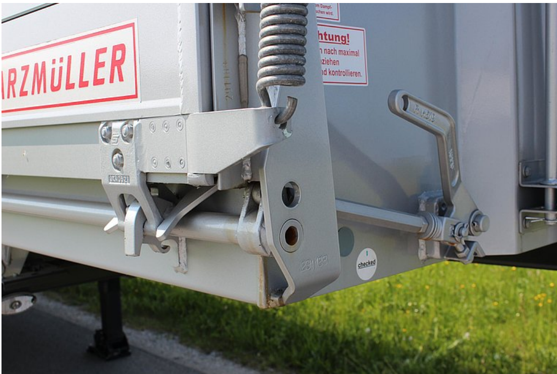
Manuální centrální ovládání k otevírání bočnic prostřednictvím páky a centrální uzavírací tyče
