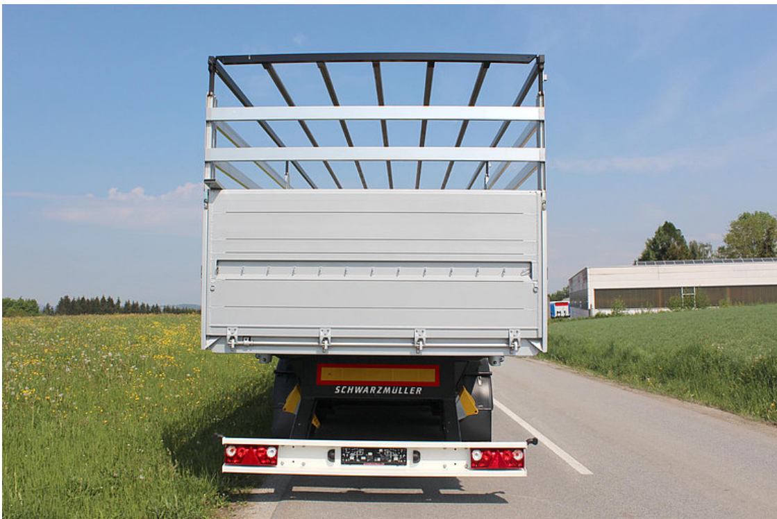
Zadní stěna z dutých hliníkových profilů, sklopná s prodlouženými uzávěry, rovněž výkyvná s dodatečným manuálním centrálním ovládáním
