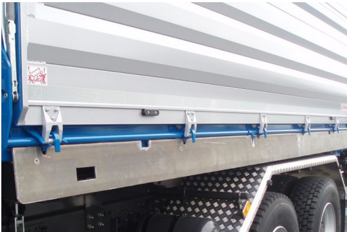
VOLITELNĚ: hliníková výsypná lišta na boční centrální uzavírací tyči
