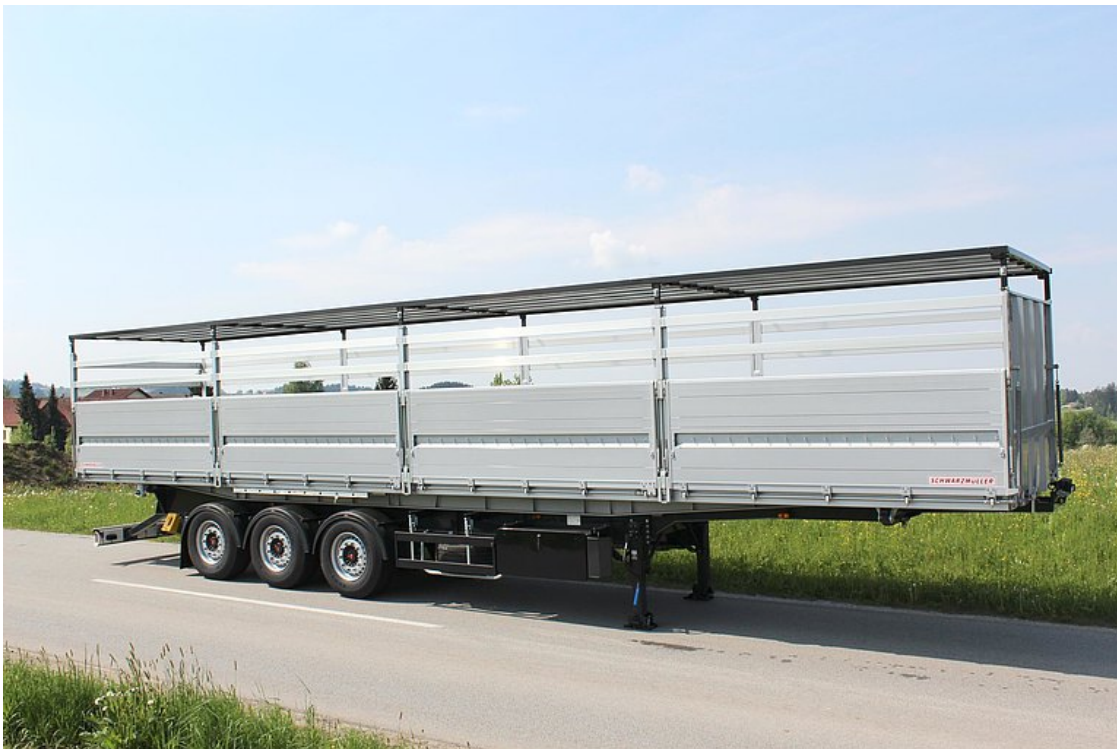
Třínápravový třístranný sklápěcí návěs - pro dálkovou přepravu
