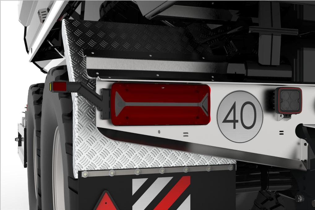
Die gesamte Beleuchtung am Fahrzeug ist geschützt montiert und in Voll-LED und Multivolt (12/24V) ausgeführt.
