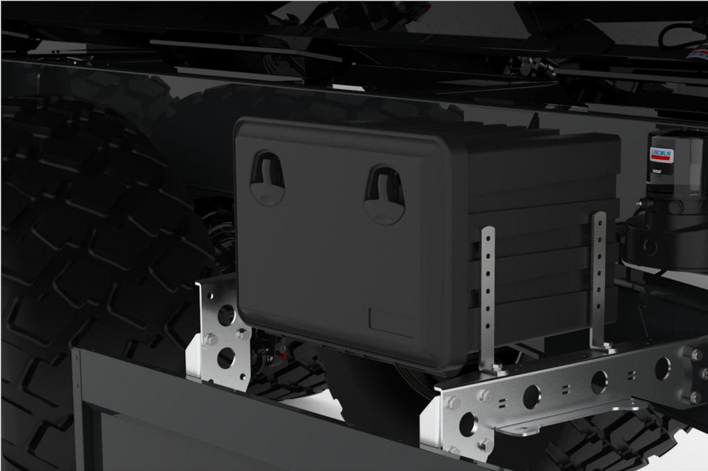
OPTIONAL: Der Kunststoff Werkzeugkasten sorgt für Staumöglichkeit.
