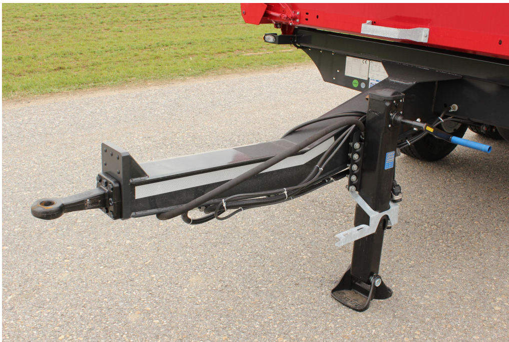
Zalomená tažná oj s výškově stavitelným šroubovaným okem oje včetně 1 výstupného třmenu ve směru jízdy vlevo
