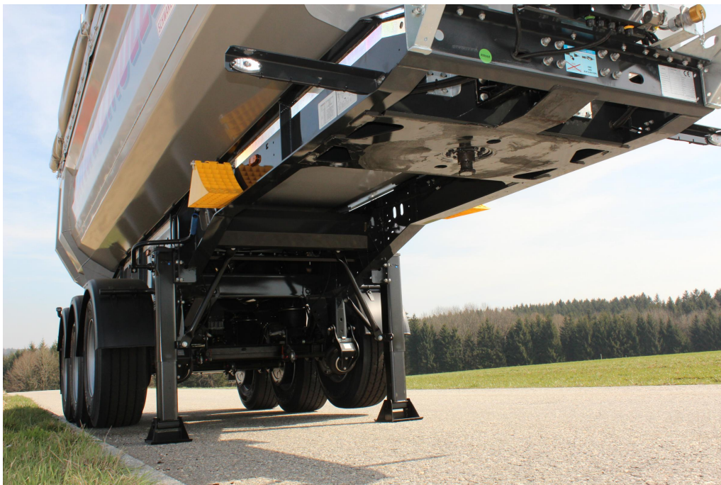
Stabilní a tuhá konstrukce podvozku s dodatečnými torzními profily
