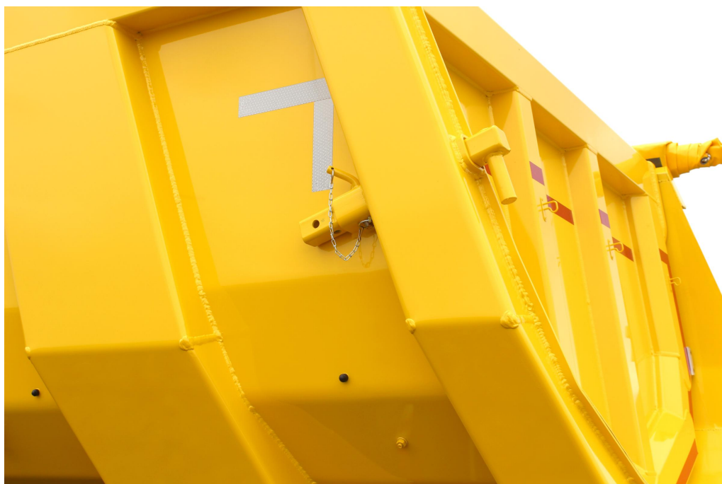
3-nápravový sklápěcí návěs s hliníkovou korbou v segmentovém provedení
