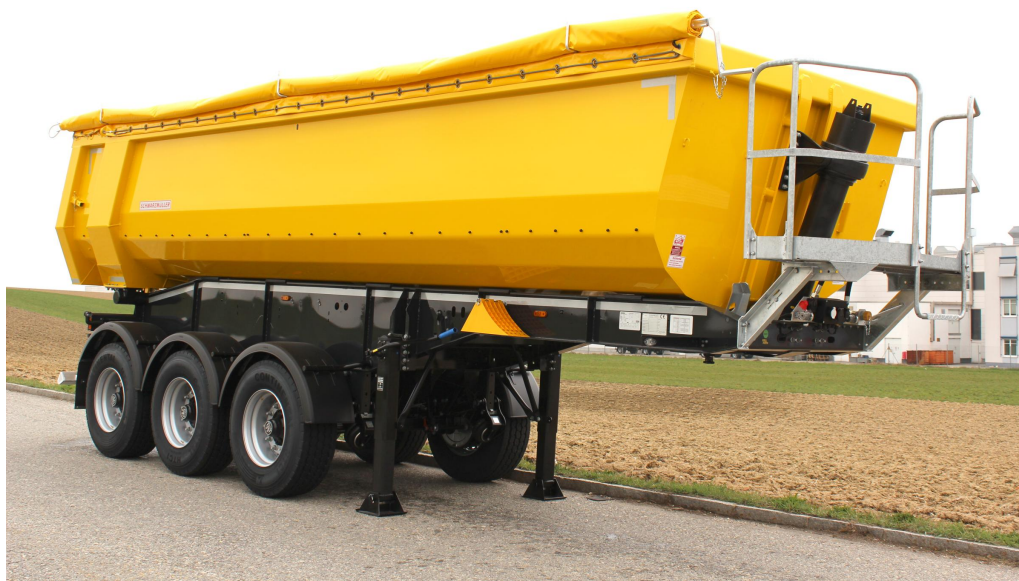
3-nápravový sklápěcí návěs s hliníkovou korbou v segmentovém provedení
