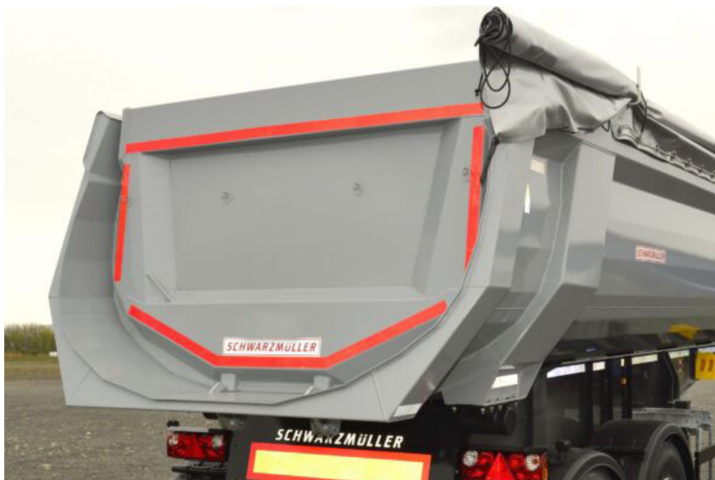
Stahl-Rückwand = Pendelwand mit versenkter Lagerung und autom.-mech. 2-Haken-Zentralverschluss
