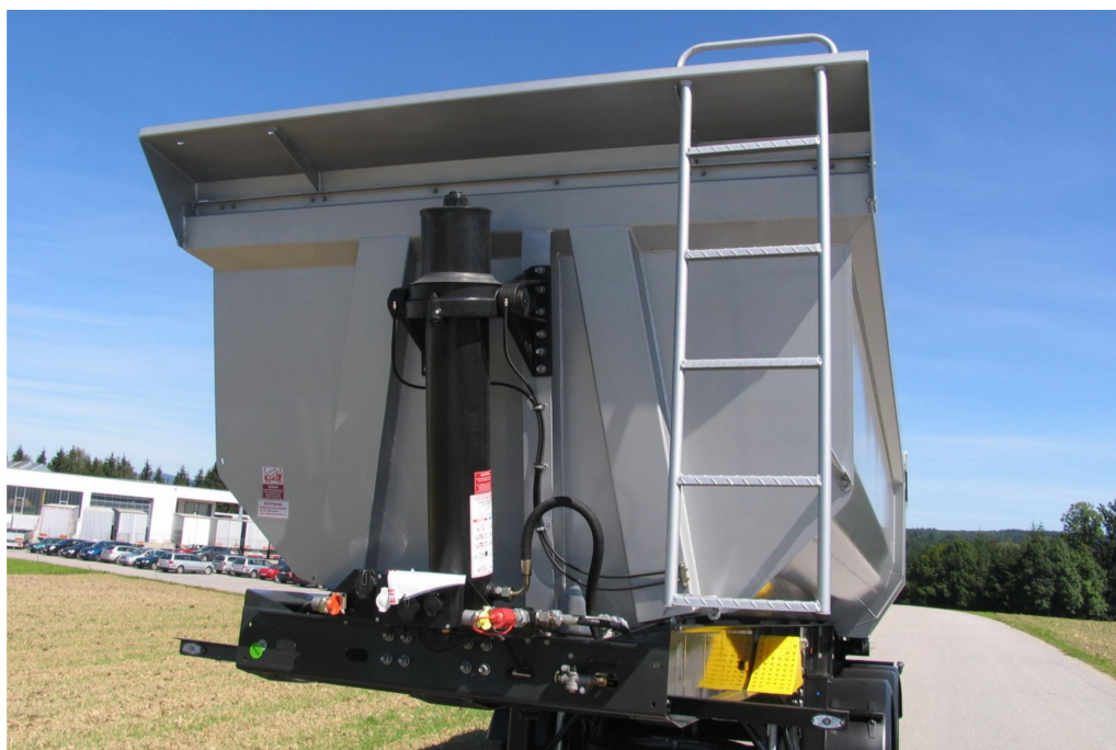
Stahl-Rückwand = Pendelwand mit versenkter Lagerung und autom.-mech. 2-Haken-Zentralverschluss
