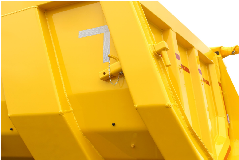
VOLITELNĚ: dávkovací zařízení pro výkyvnou zadní stěnu s výsuvnými dorazy
