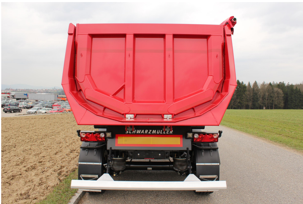
VOLITELNĚ: dávkovací zařízení pro výkyvnou zadní stěnu s výsuvnými dorazy
