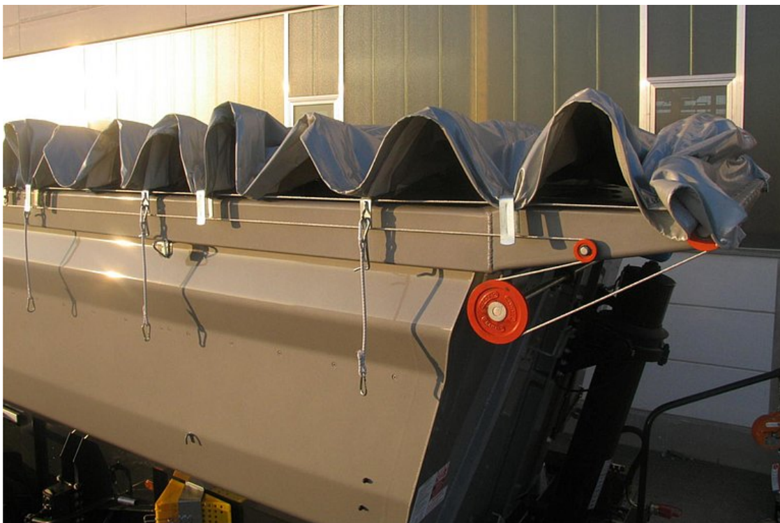
VOLITELNĚ: stahovací střecha - dle výběru - manuální ovládání nebo prostřednictvím elektrického dálkového ovládání
