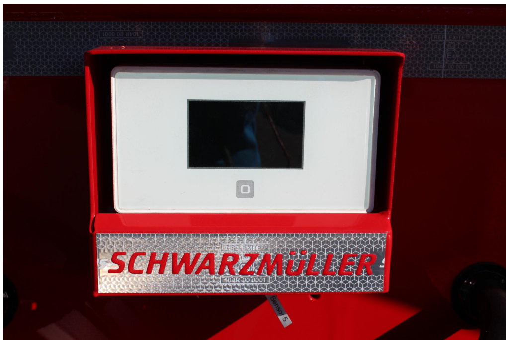
Jednotka pro vyhodnocování teploty v robustní schránce
