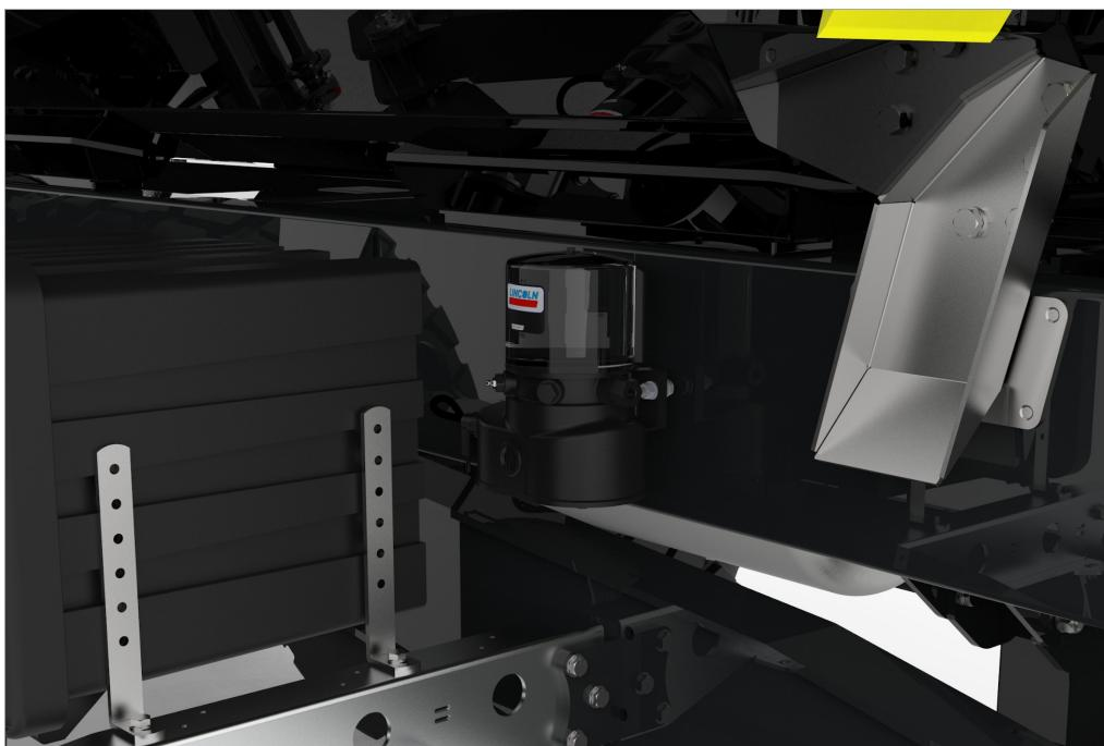
OPTIONAL: Die Zentralschmieranlage versorgt das gesamte Fahrzeug mit dem benötigten Schmierstoff.
