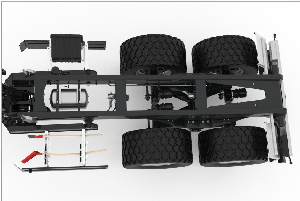
Diese spezielle Rahmenkonstruktion in großdimensionierter Formrohrausführung wird als Hauptträger verwendet.
