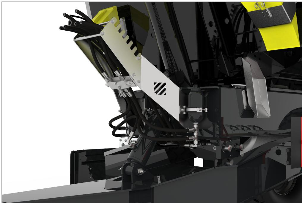
Die 4 t Deichsel in V-Ausführung ist komfortabel mit hydraulischer Deichseldämpfung ausgeführt. Dies nimmt Schläge auf und gewährt ein angenehmes Fahrverhalten.
