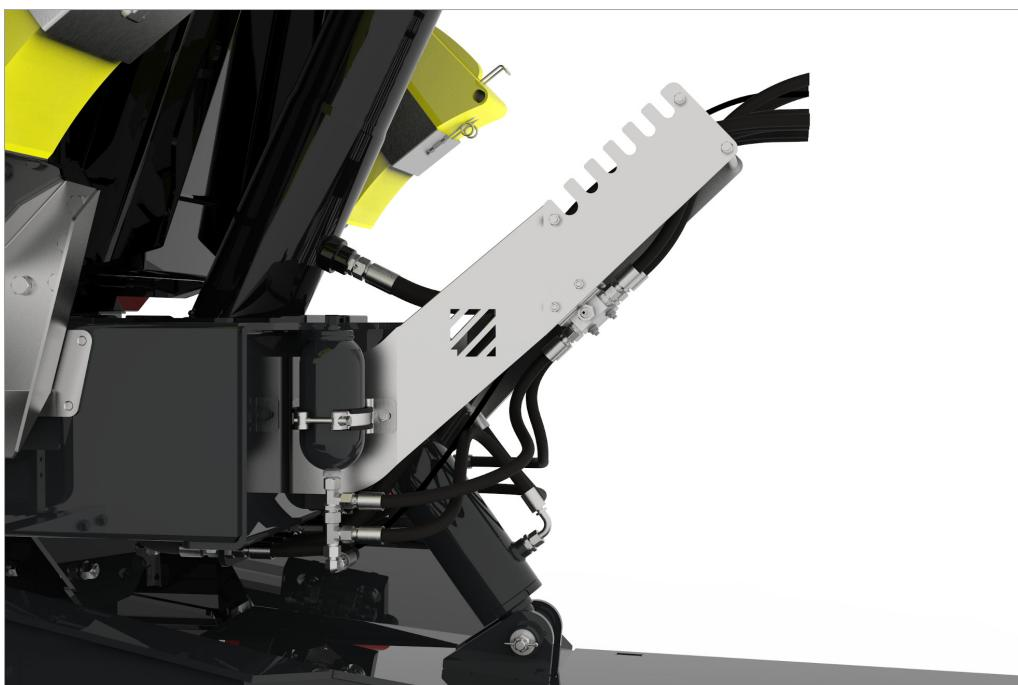
Alle Verbindungsleitungen sind geschützt in einem Schlauchturm geführt um eine optimale Verbindung zum Zugfahrzeug zu gewährleisten.
