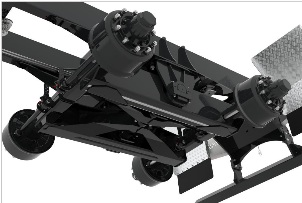
Das BPW - Pendelaggregat in 30 t Schwerlastausführung mit seitenunabhängigem Achsausgleich sorgt mit einer 650/55 R26,5" Bereifung für einen perfekten Straßenlauf und gewährt eine optimale Geländegängigkeit.
