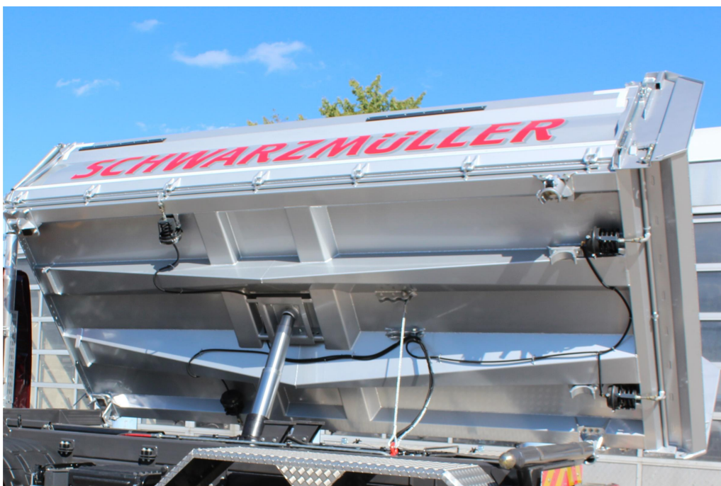
Stabilní a tuhá konstrukce podvozku s dodatečnými torzními profily pro třístranné sklápění
