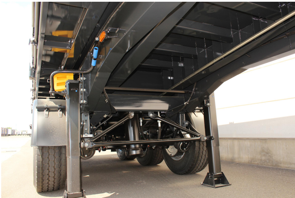
Stabilní a tuhá konstrukce podvozku s dodatečnými torzními profily pro třístranné sklápění
