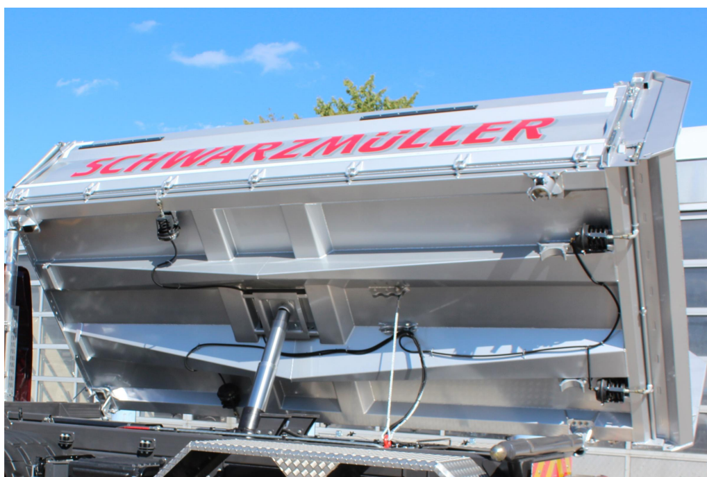
Dvounápravový třístranný sklápěcí návěs - stavební provedení
