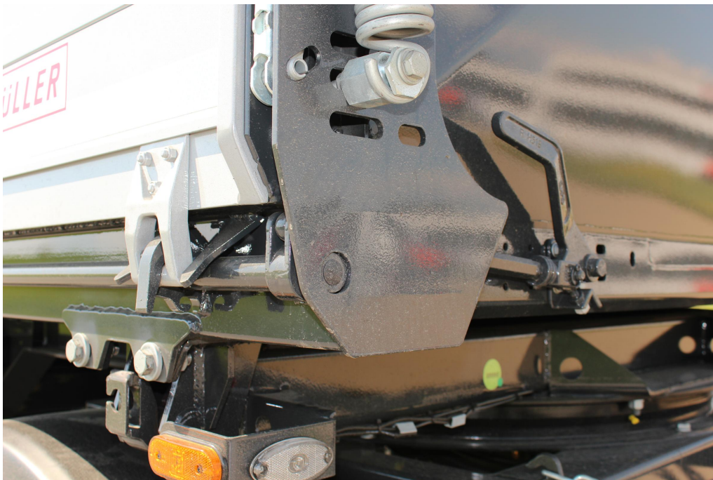
Manuální centrální ovládání k otevírání bočnic prostřednictvím páky a centrální uzavírací tyče
