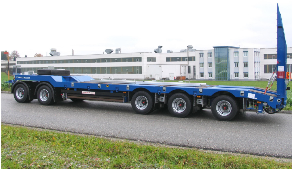
5-nápravový nízkoložný přívěs se zalomeným rámem
