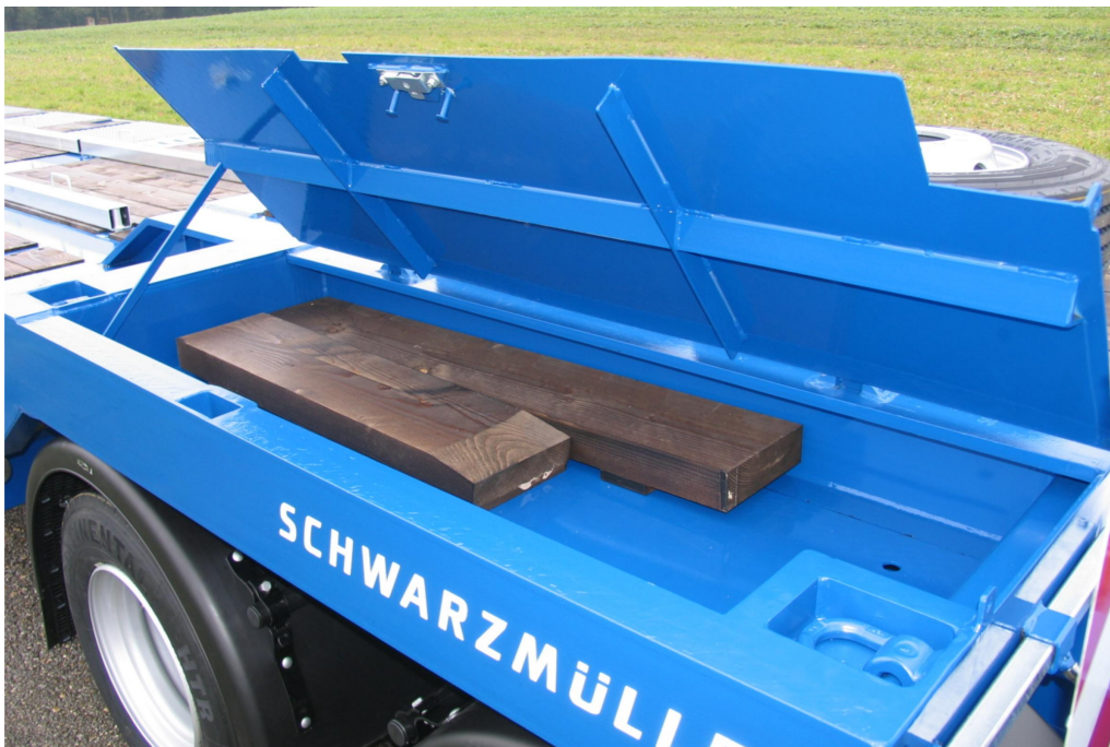
Vpředu ve vyvýšené plošině 2 uzavíratelné úložné prostory
