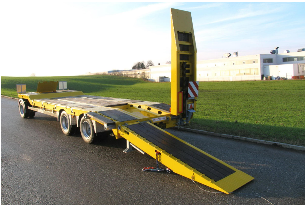
Vpředu točna vč. tažné oje a výsuvných varovných tabulí pro přepravu nadměrně širokých nákladů
