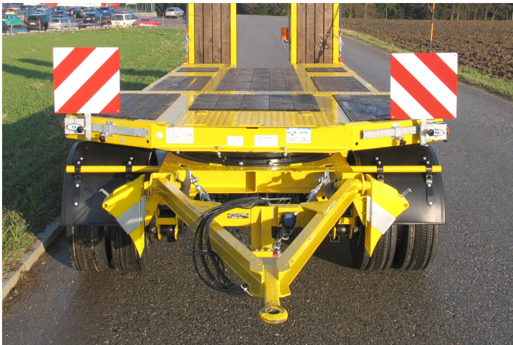
Vpředu točna vč. tažné oje a výsuvných varovných tabulí pro přepravu nadměrně širokých nákladů
