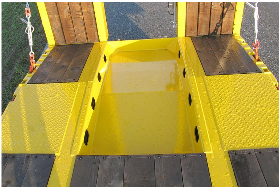
Mulda pro lžici bagru - vybrání vzadu mezi podélníky
