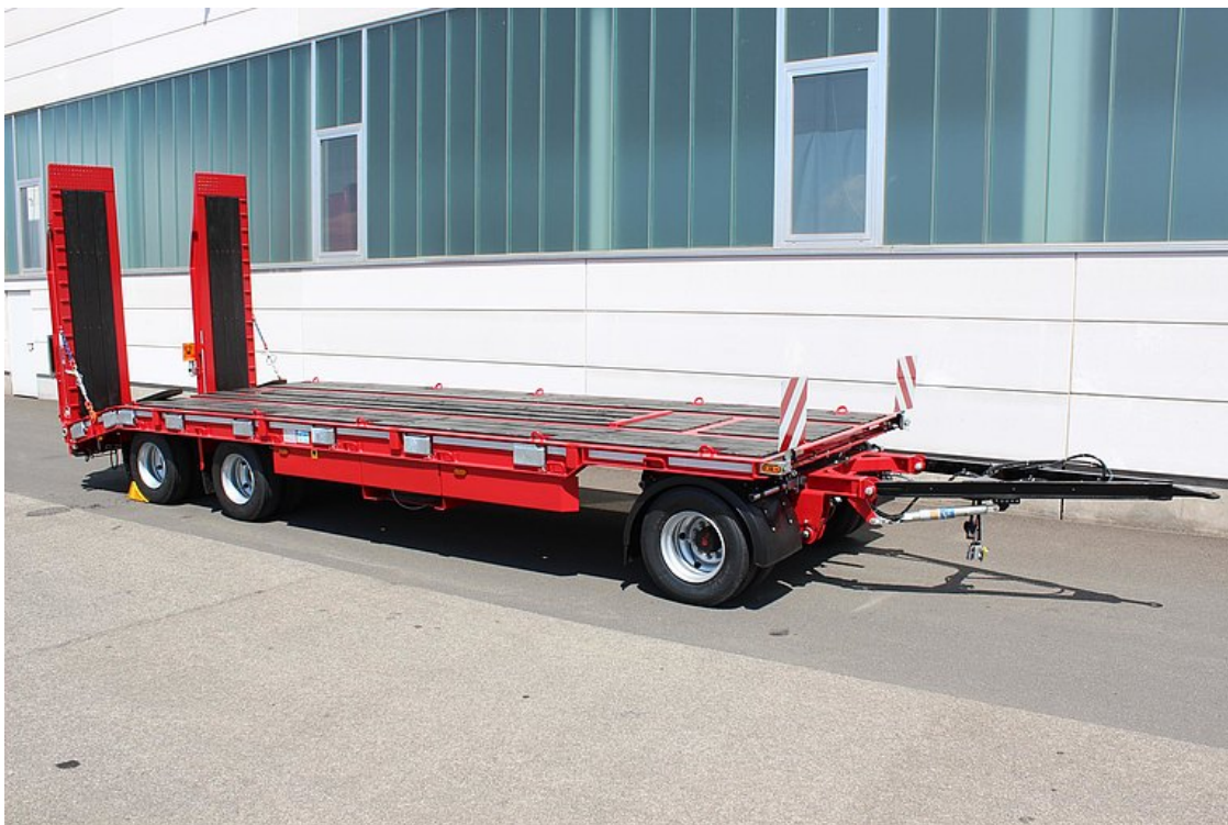
Třínápravový nízkožný přívěs s rovnou plošinou
