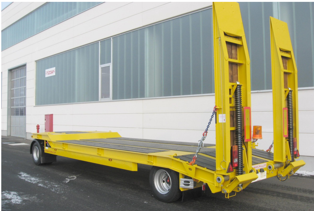
Dvounápravový nízkoložný přívěs se zalomením rámu
