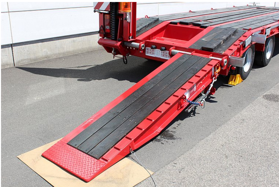
Nájezdové rampy s vyložením z tvrdého dřeva a navařenými čtyřhrany
