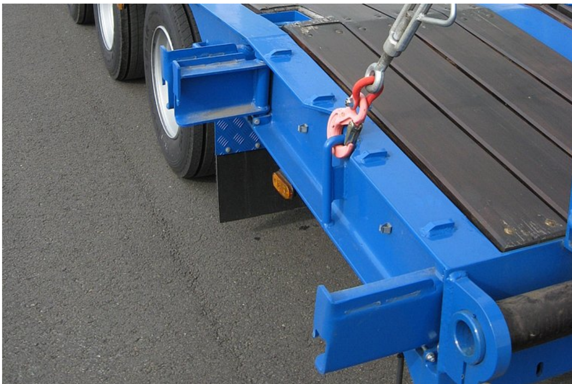
Sklopná, vytahovatelná rozšíření vč. rozšiřujících fošen pro přepravu nadměrně širokých nákladů
