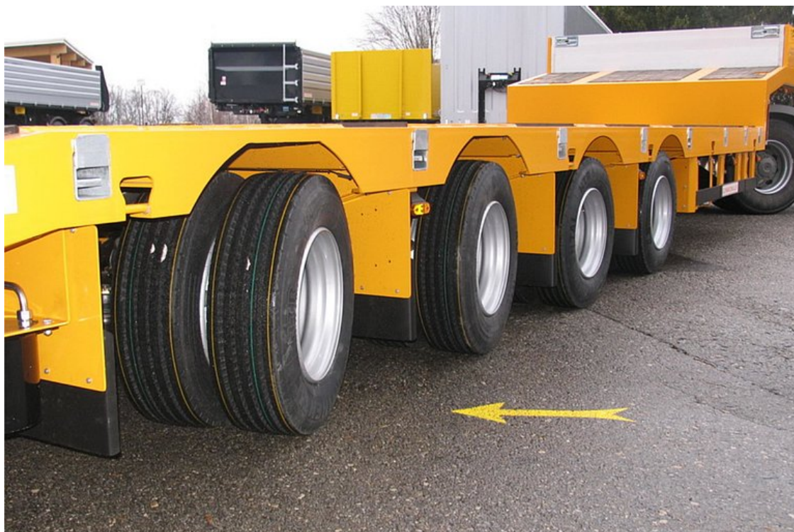
3. a 4. náprava natáčivá, pro lepší průjezd zatáčkou a nižší opotřebení pneumatik
