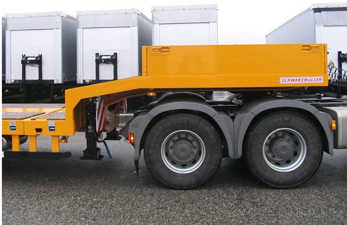
Vpředu zvýšená zalomená plošina vč. nasazovacích bočnic
