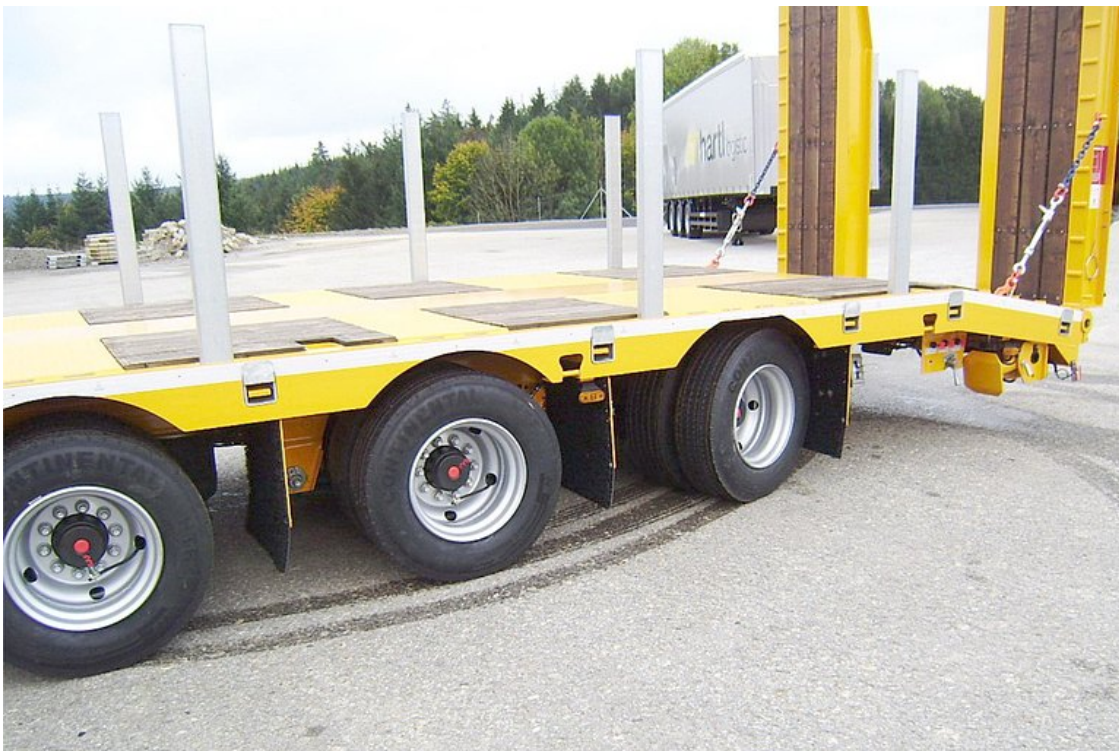
3. náprava natáčivá, pro lepší průjezd zatáčkou a nižší opotřebení pneumatik
