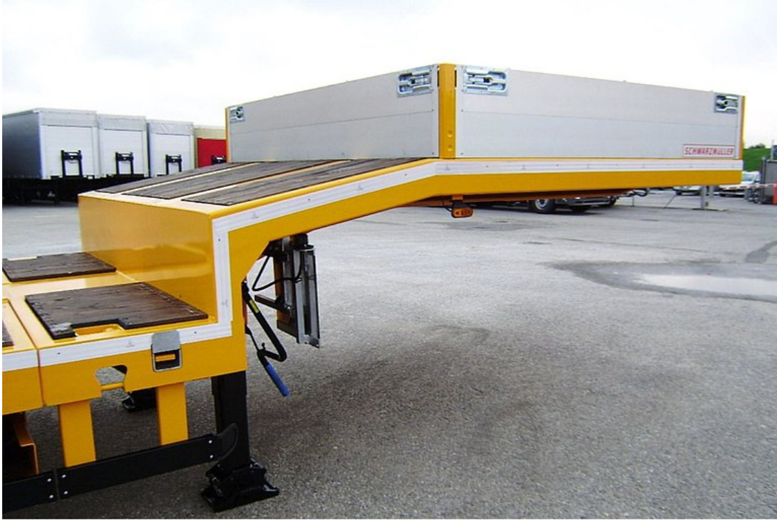
Vpředu zvýšená zalomená plošina vč. nasazovacích bočnic
