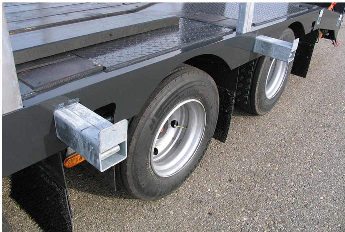
Výsuvné rozšíření vč. dřevěných fošen pro přepravu nadměrně širokých nákladů
