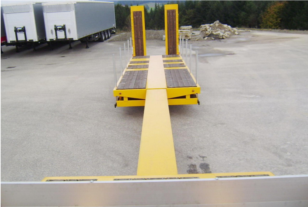
Základní ložná plocha s podlahou z měkkého dřeva a klanicemi ve vnějším rámu
