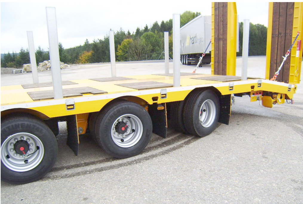
Základní ložná plocha s podlahou z měkkého dřeva a klanicemi ve vnějším rámu
