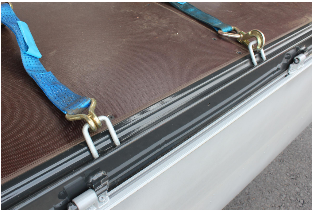
Vnější rám se zapuštěnými 2,5 t kotevními třmeny
