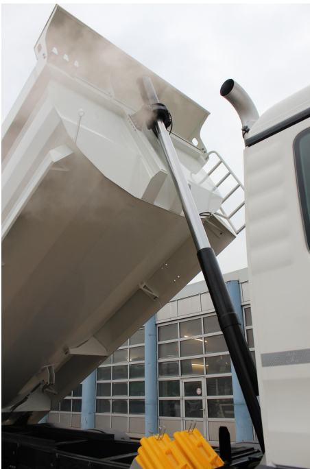
Automatický, mechanický uzávěr zadního čela
