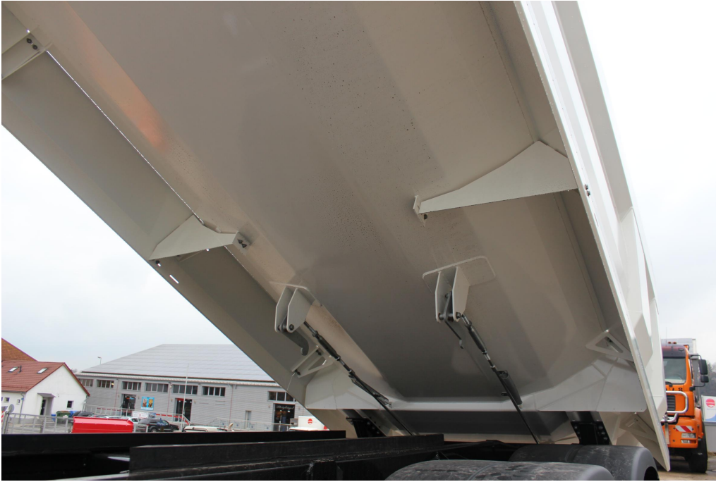
Nejlepší možná ochrana proti nárazům a opotřebení díky speciálně naohýbané muldě
