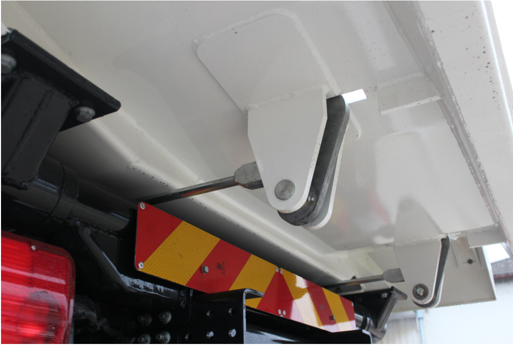
Automatický, mechanický uzávěr zadního čela
