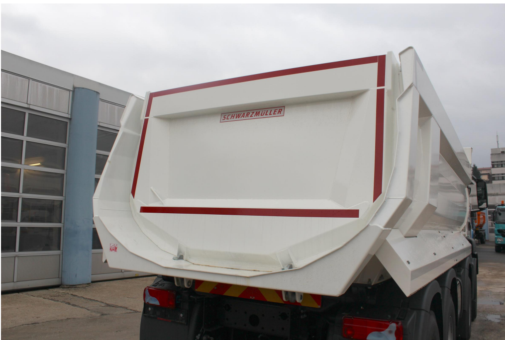
Přední stěna se zvýšeným ochranným kšiltem
