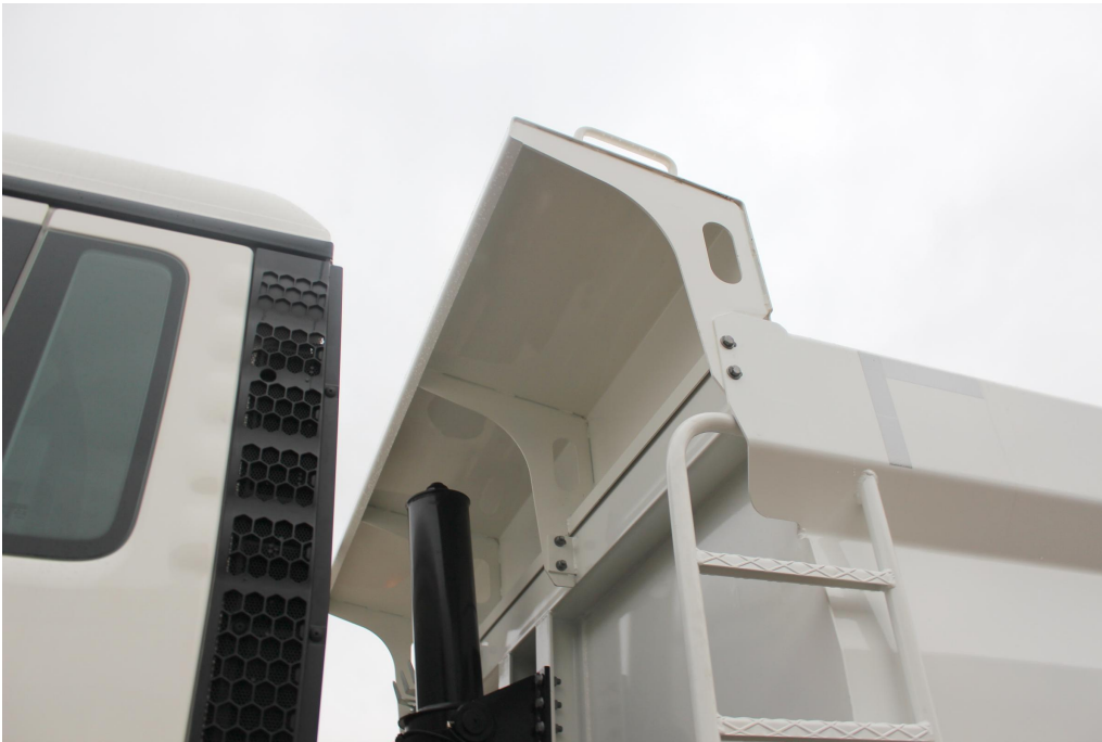
Přední stěna se zvýšeným ochranným kšiltem
