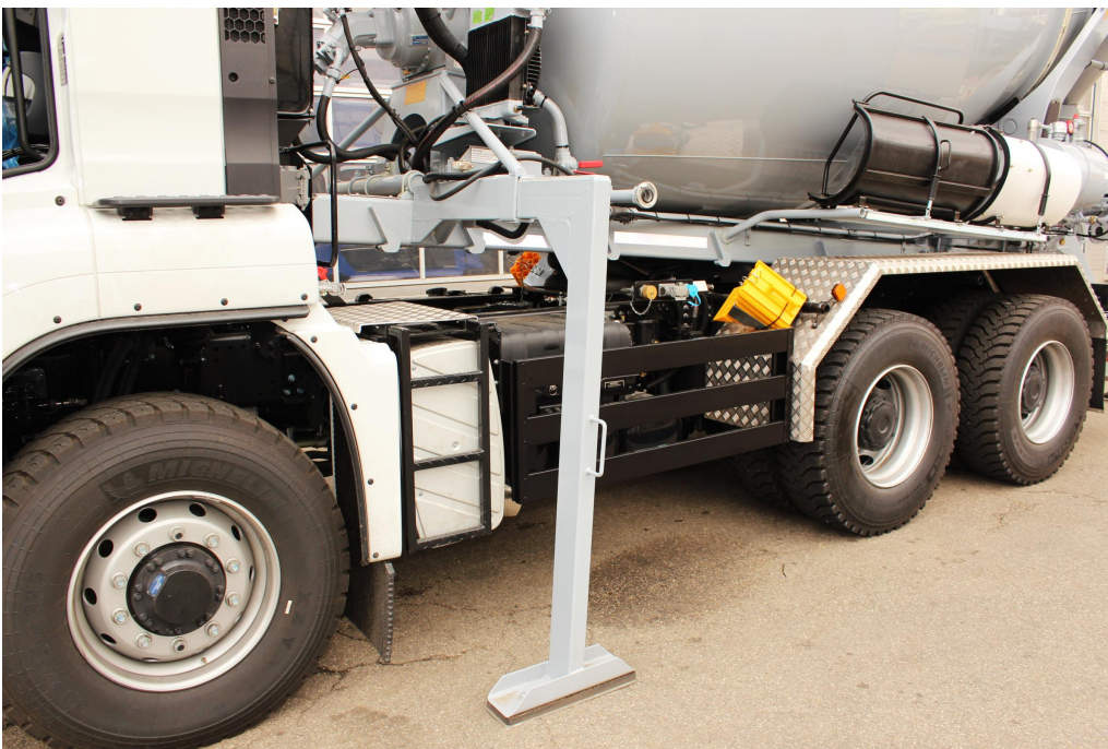
Rychloupínací výměnná 3-stranná sklápěcí nástavba - domíchávač betonu
