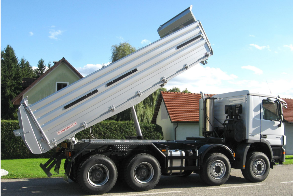
3-stranná sklápěcí nástavba na 4-nápravový podvozek - stavební provedení
