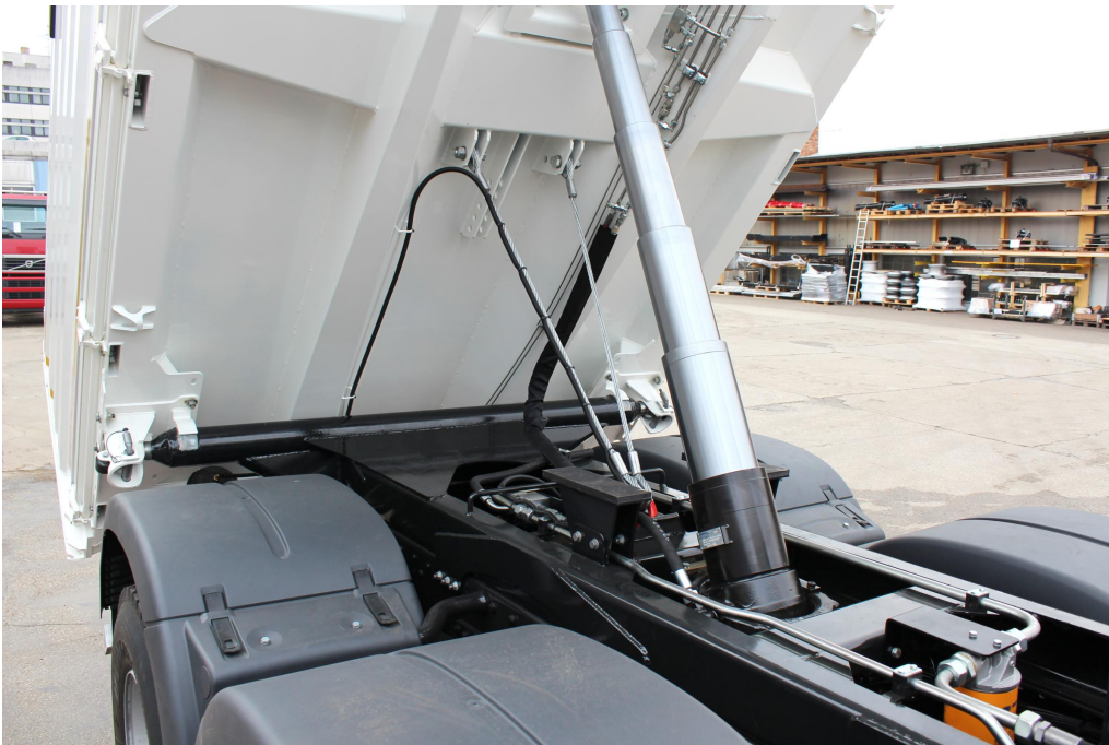
3-stranná sklápěcí nástavba na 4-nápravový podvozek - stavební provedení
