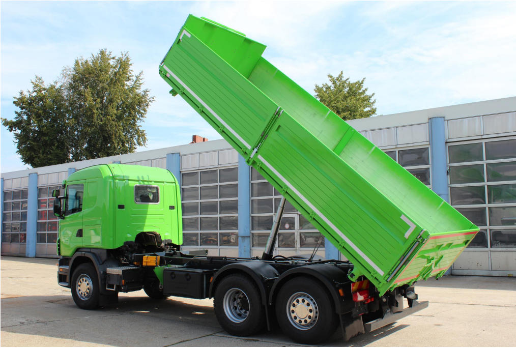
3-stranná sklápěcí nástavba na 3-nápravový podvozek - pro dálkovou přepravu
