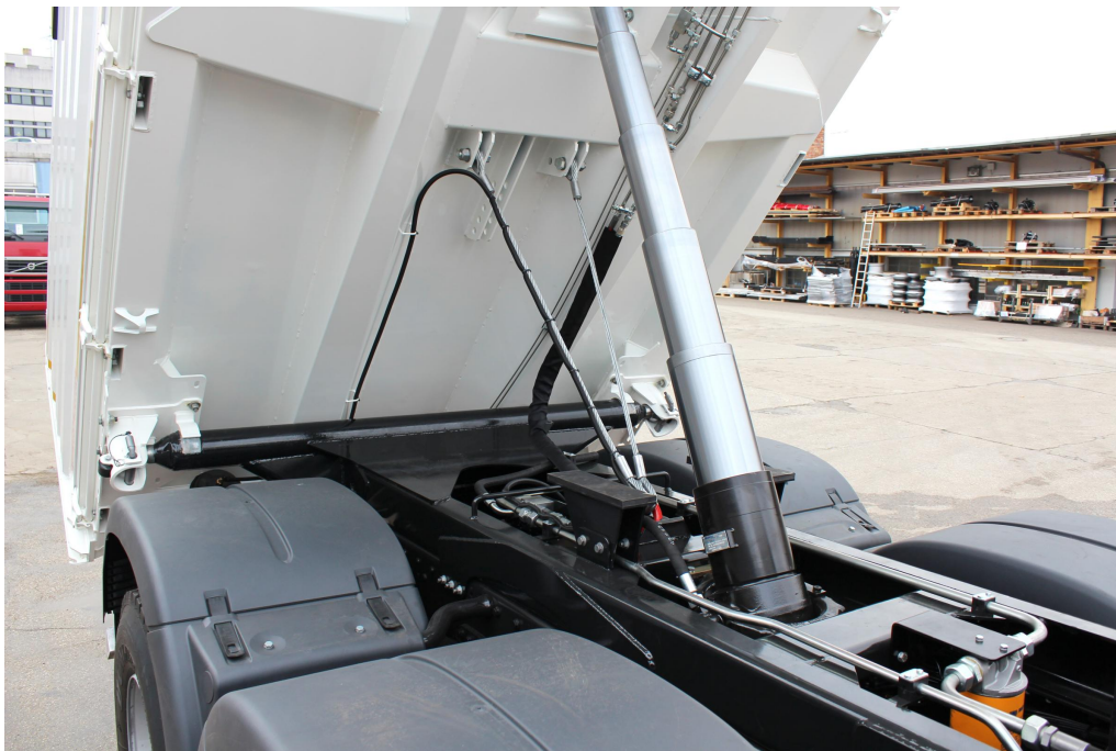
Tvrdě chromovaný, vysoce kvalitní hydraulický válec (hydromotor)
