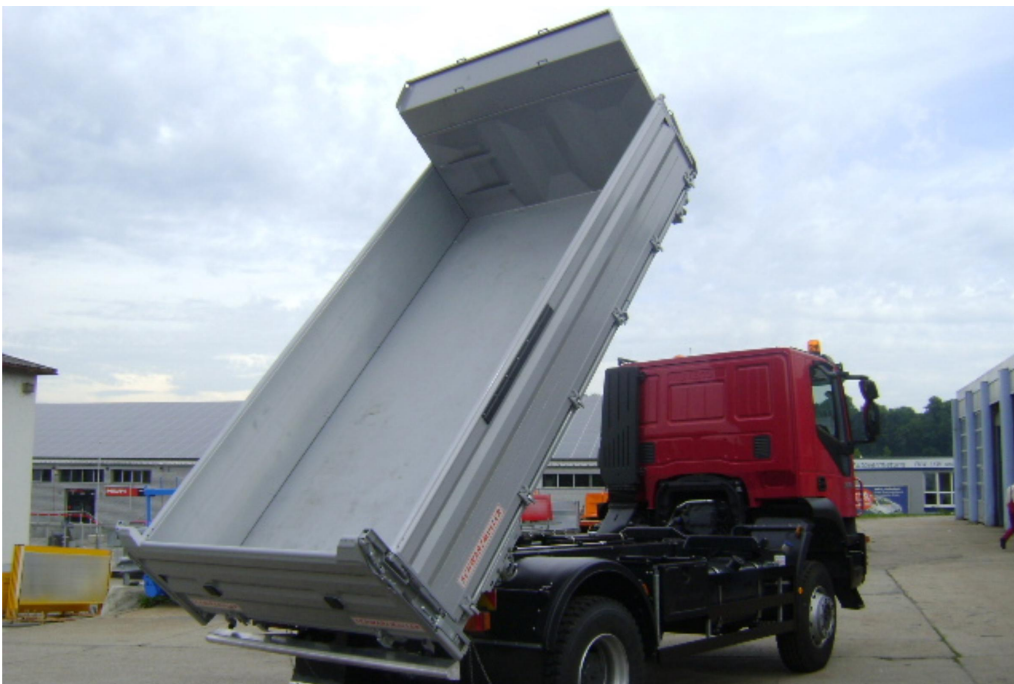
3-stranná sklápěcí nástavba na 2-nápravový podvozek - stavební provedení
