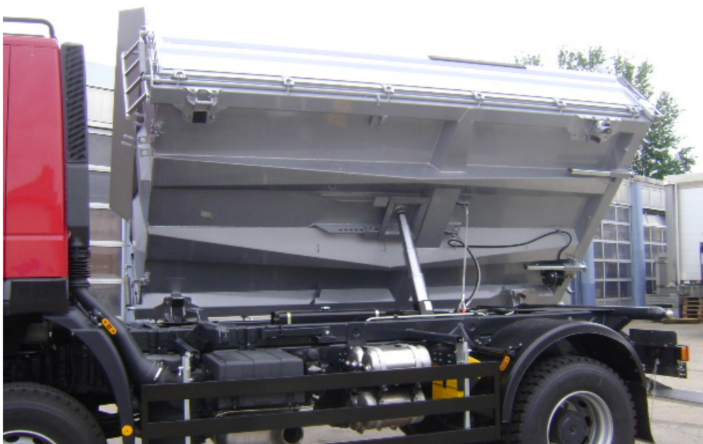
Konstrukce sklápěcí korby tvořená kónickými podélníky trapézového profilu ve vysokopevnostním lehkém provedení s malými podlahovými úseky pro vysokou odolnost proti bouřím a vysokou pružností tlumení nárazů
