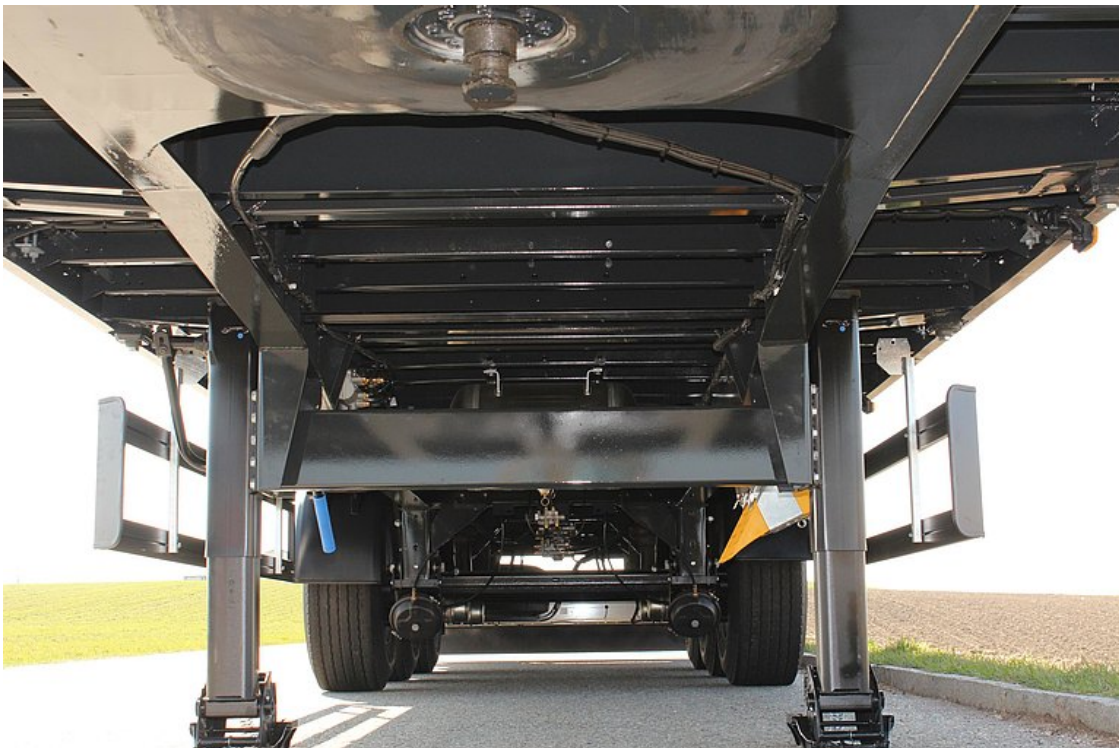
Odlehčený rám z vysokopevnostní speciální oceli NAXTRA - úspora hmotnosti až 500 kg
