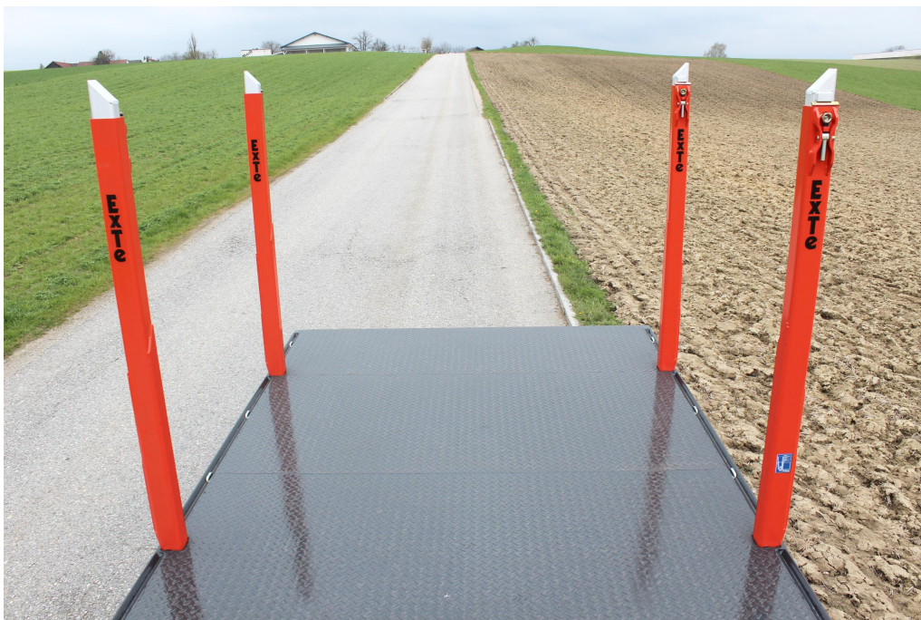
Podlaha z ocelového žebrovaného plechu 5/7 mm, bodově přivařena
