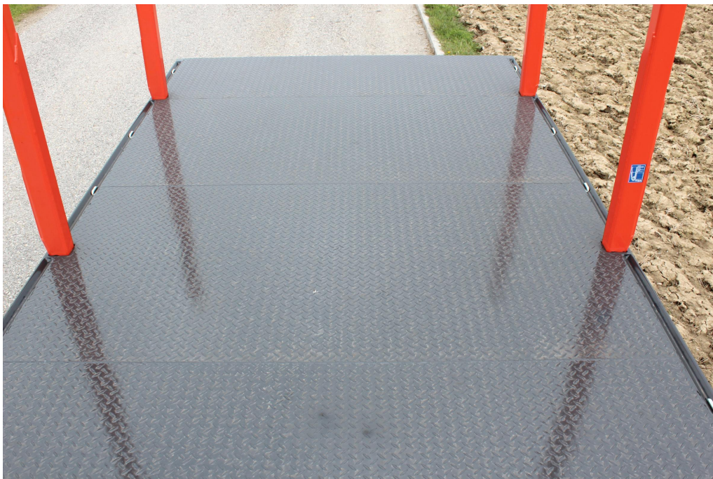
Podlaha z ocelového žebrovaného plechu 5/7 mm, bodově přivařena
