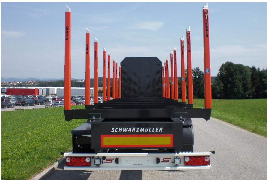
VOLITELNĚ: Extra silná ocelová přední stěna vysoká cca 2.500 mm, se středovými opěrami
