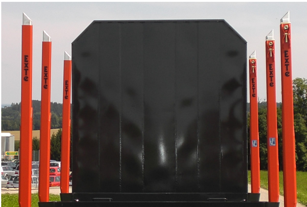
VOLITELNĚ: Extra silná ocelová přední stěna vysoká cca 2.500 mm, se středovými opěrami
