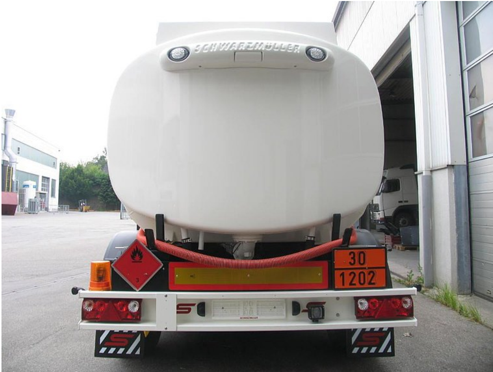
VOLITELNĚ: vysoko umístěný držák LED-světel s možností integrované zpětné kamery pro bezpečné couvání
