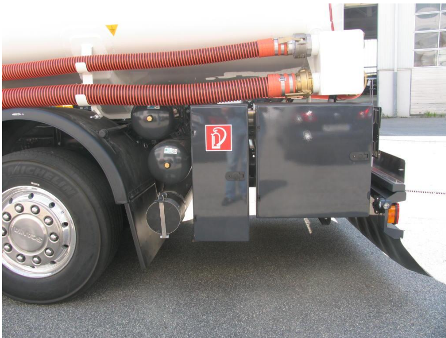
Vlevo a vpravo hliníková schránka pro ovládání měřicí tyče s malou vodováhou
