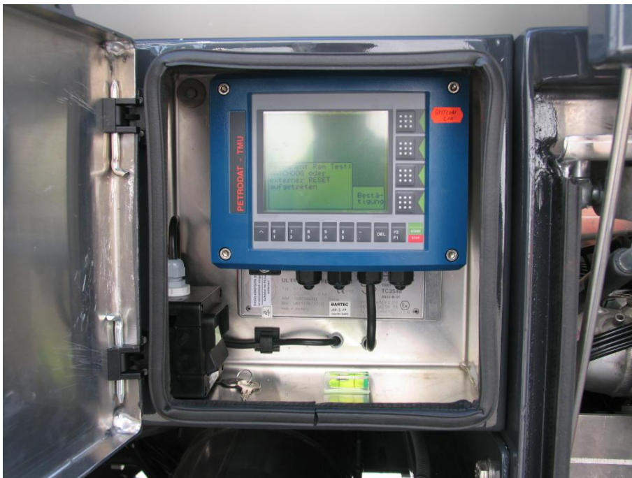
Vlevo a vpravo hliníková schránka pro ovládání měřicí tyče s malou vodováhou
