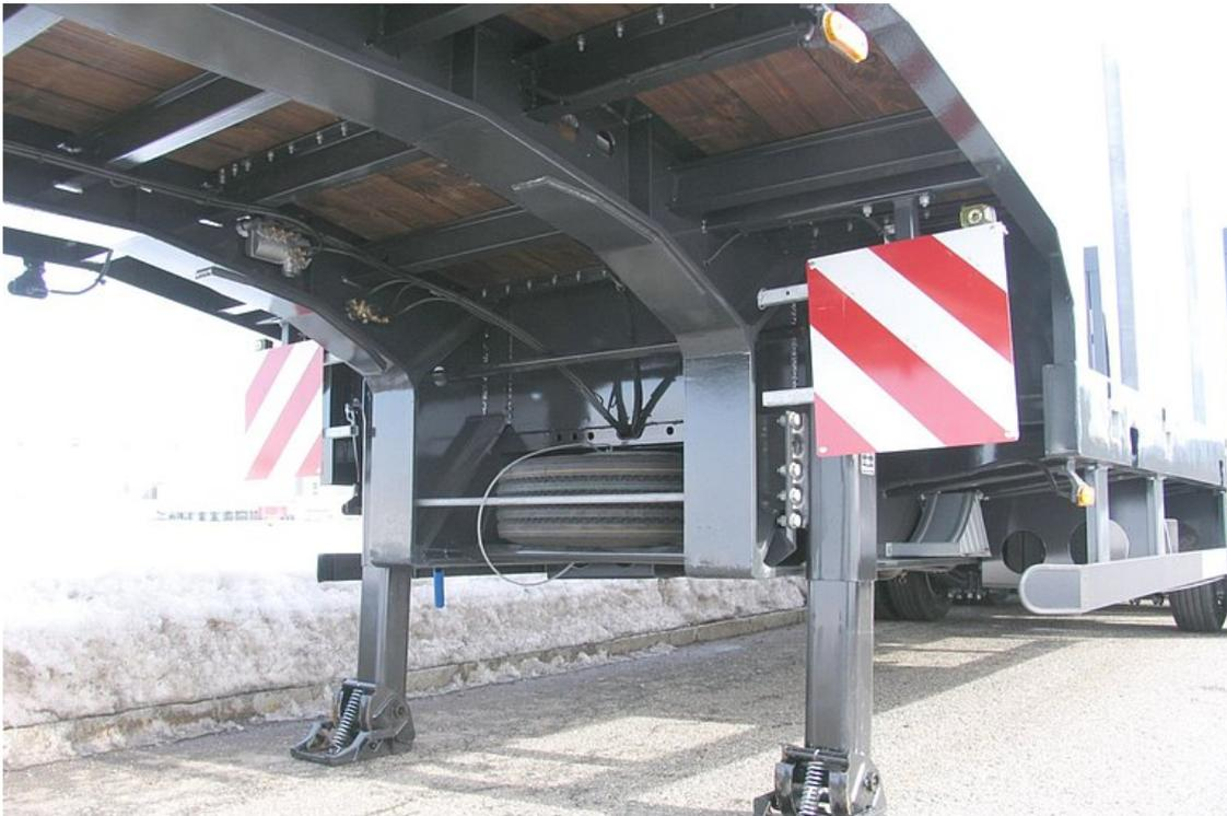
Verstärkte und verwindungssteife Stahlschweißkonstruktion mit engem Querträgerabstand für hohe Punktbelastung
