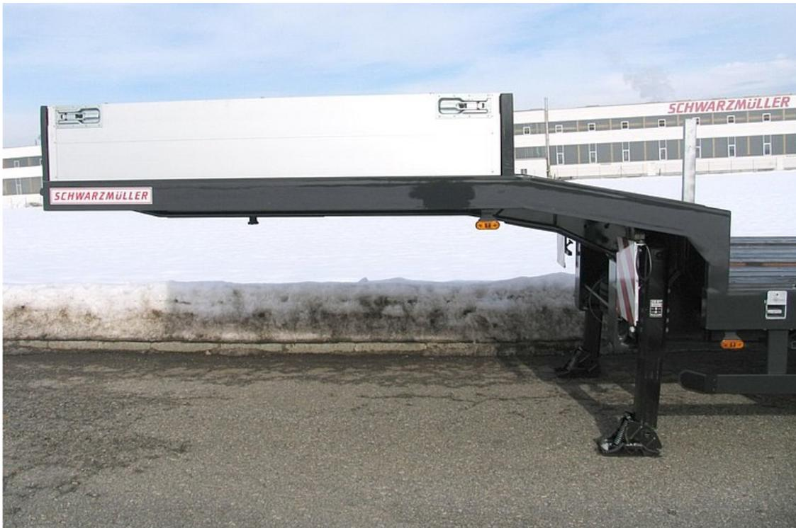
Vorne erhöhtes Kröpfungspaneau inkl. steckbare Bordwände
