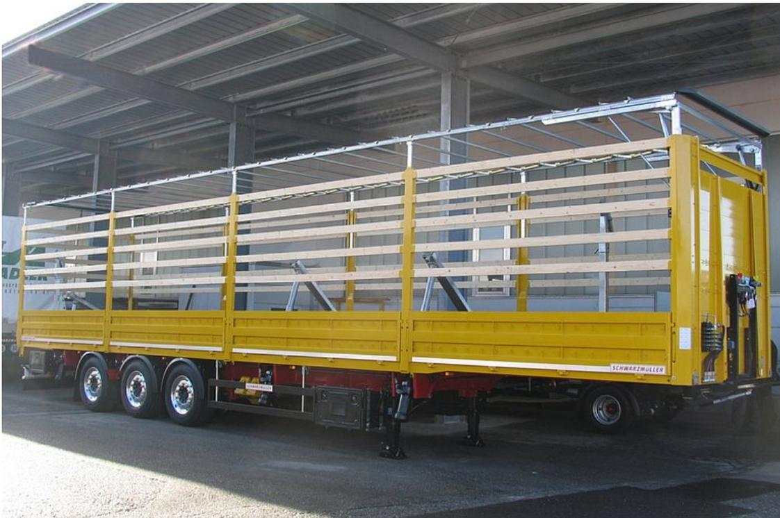
3-Achs-Leichtbau-Plateausattelanhänger - Coil - Schrägverlader
