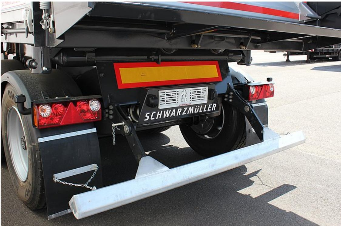
Klappbarer Unterfahrschutz für Fertigerinsatz
