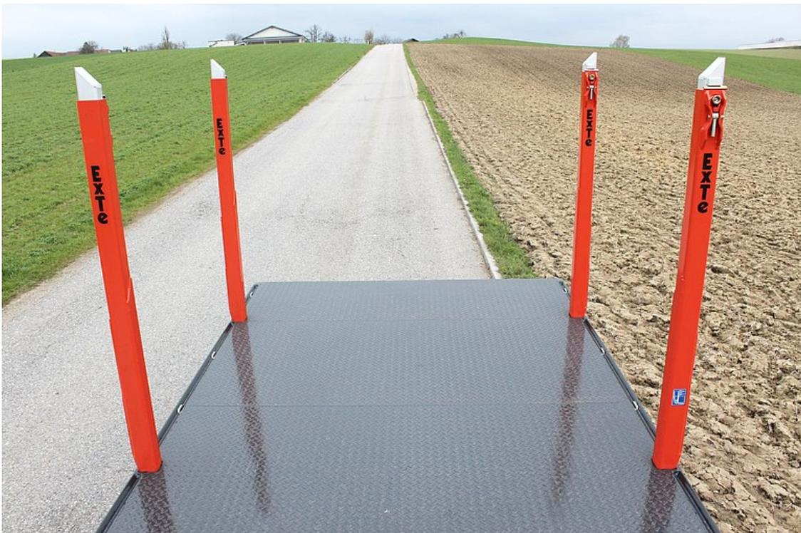
Exte-Rungentaschen mit Verstärkungsträger samt 2-teiligen Exte-Rungen 144-S mit Schraubenbefestigung
